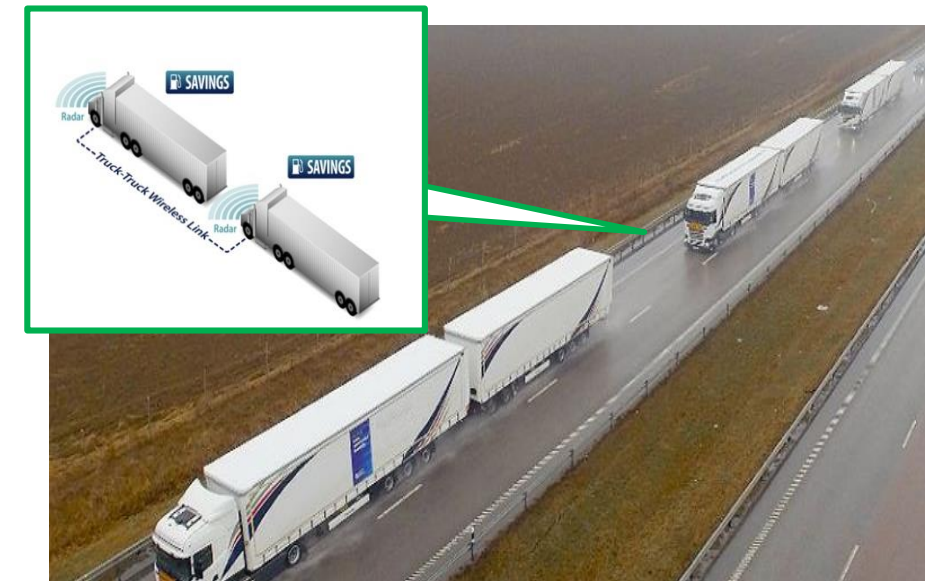
Fig. 2.5.v - Principi di funzionamento del platooning
